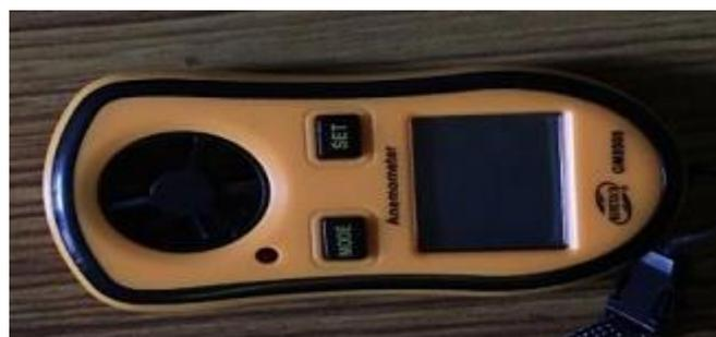
Fig. 5 LCD Wind Speed Gauge Meter Anemometer
